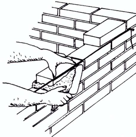
Figura 9- Retirada do excesso de argamassa
